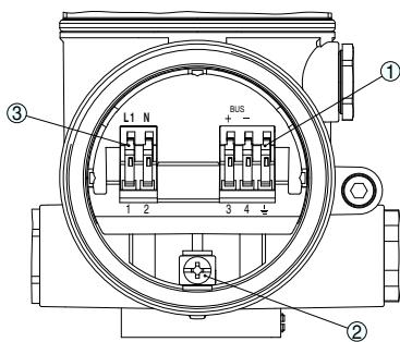
Отсек подключения (двухкамерный корпус)
